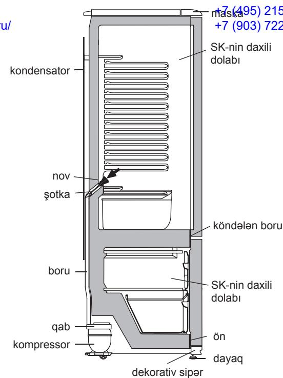
Şəkil 4 — SK-dən qar suyunun axma sistemi
