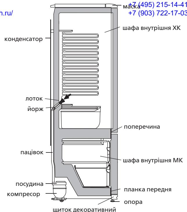
Рисунок 4 – Схема зливу талої води із ХК
