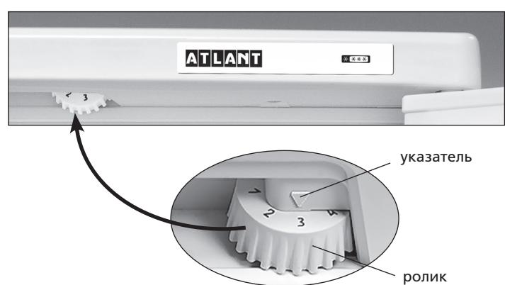
Рисунок 3 — Регулировка температуры
