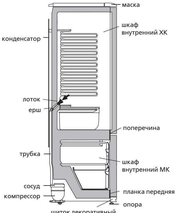
Рисунок 4 – Схема слива талой воды из ХК
